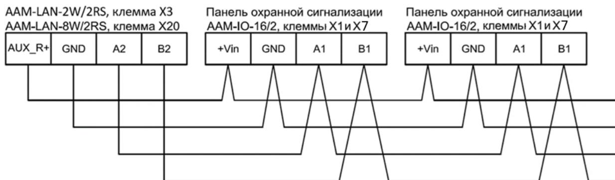
Рисунок 2. Подключение панелей охранной сигнализации ААМ-IO-16/2, подключаемых на один шлейф к ведущему ААМ-LAN-8W/2RS или ААМ-LAN-2W/2RS.
